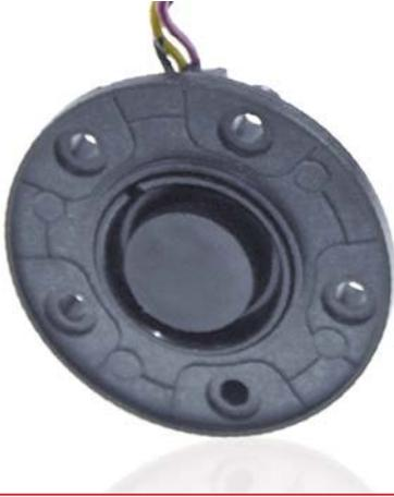
Der Ultraschall-Tanksensor MOTOSONIC generiert ein Ultraschallsignal, sendet es in Richtung der Flüssigkeitsoberfläche und misst die Laufzeit, welche die hochfrequente Schallwelle für die Strecke zwischen Sensor und Flüssigkeitsoberfläche hin und zurück benötigt. Ausgehend von der gemessenen Zeit und der Schallgeschwindigkeit kann die Entfernung zwischen Sensor und Flüssigkeitsoberfläche und damit der Tankinhalt berechnet werden.
